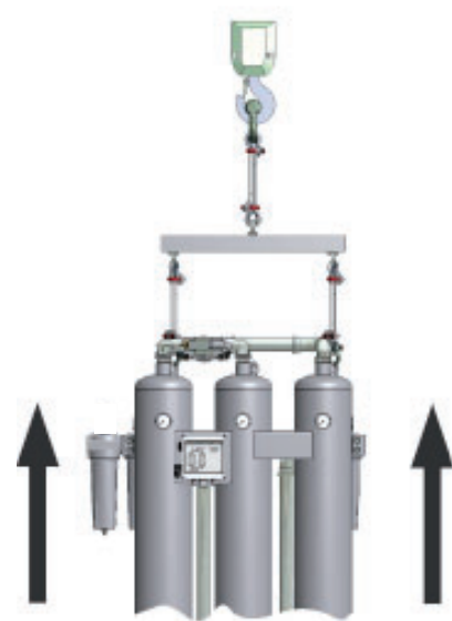
II: Aufstellen mit Kran
